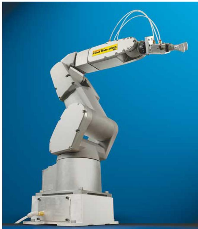
**Промышленный робот** — это предназначенный для выполнения двигательных и управляющих функций в производственном процессе манипуляционный робот, т. е. автоматическое устройство, состоящее из манипулятора и перепрограммируемого устройства управления, которое формирует управляющие воздействия, задающие требуемые движения исполнительных органов манипулятора. Применяется для перемещения предметов производства и выполнения различных технологических операций.
